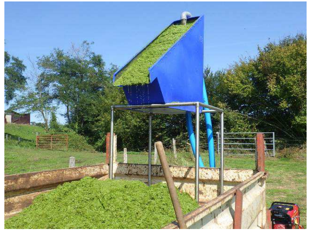
Pompage et tamisage après raclage de surface
